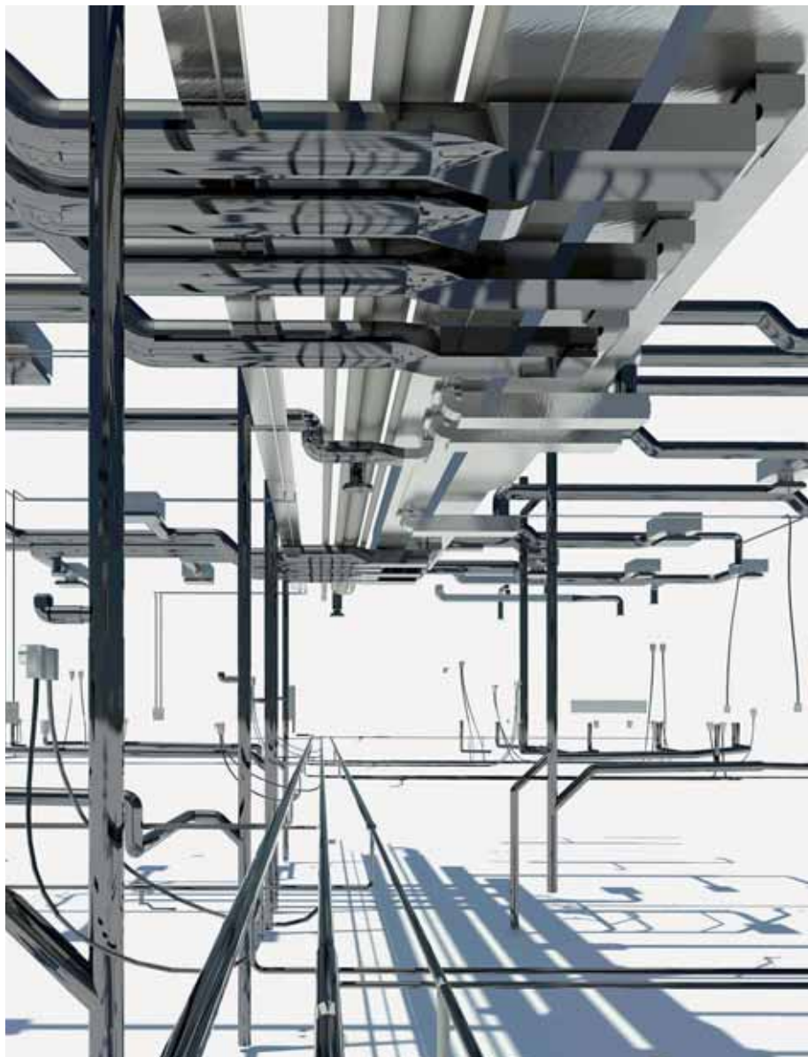
Et af de andre programmer, Søren Jensen kigger på som supplement til Revit er MagiCAD til Revit. MagiCAD understøtter Revit til optegning og projektering af rør-, ventilations-, el- og svagstrømskonstruktioner, inklusive support til beregninger og analyser.
